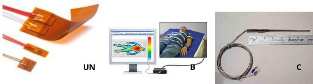
Figura 8: Possibili sensori di temperatura. A) Termistori a nastro termico [13]. B) Mappatura temperatura Tactilus [14]. C) Termocoppia [15].
